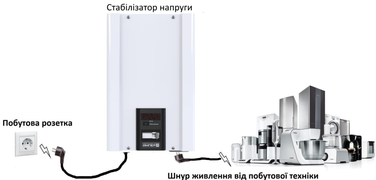
Рисунок 13. Підключення стабілізатора 5-16А до мережі
