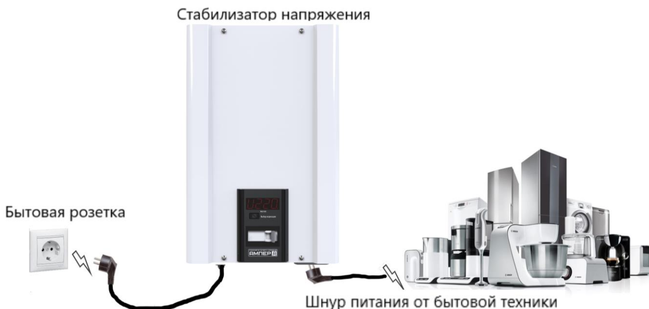
Рисунок 14. Подключение стабилизатора АМПЕР на 5-16А к сети
