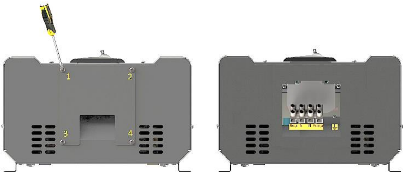
Рисунок 12. Схема зняття захисної кришки знизу корпусу стабілізатора
