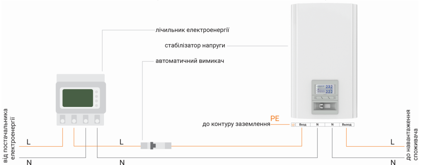
Рисунок 10. Схема підключення стабілізатора Герц і Герц-Дуо до однофазної мережі
